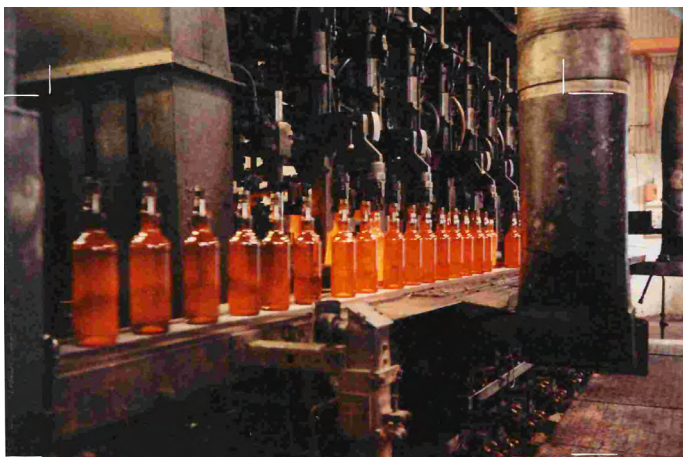
Kvalitetskontrol af glasbeholdere "i den varme ende" gav mulighed for at optimere produktionen markant. Man kunne nu finde fejl lige efter formningen af glasset i stedet for at vente en halv time til glasset var afkølet.
