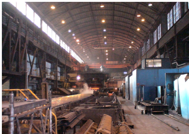
Visionsystemet på Det Danske Stålvalseværk måtte placeres 15 meter over valsestolen på grund af den kraftige varme fra de glødende slabs.
